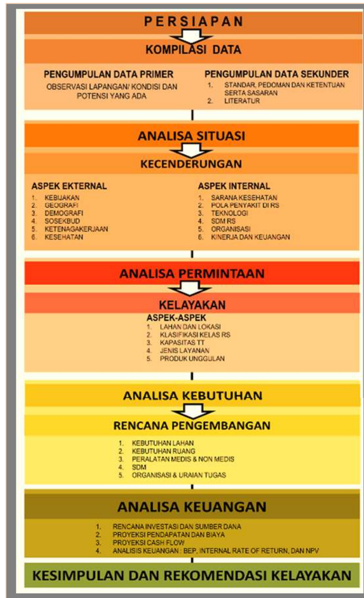
Gambar 3.3. Bagan Alir Penyusunan Studi kelayakan Rumah Sakit (berdasarkan Pedoman Penyusunan FS Rumah Sakit dari Kemenkes, 2012)
